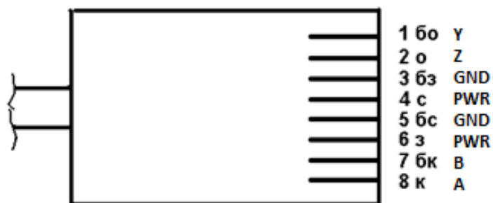
Разъём RJ45, защёлка внизу
