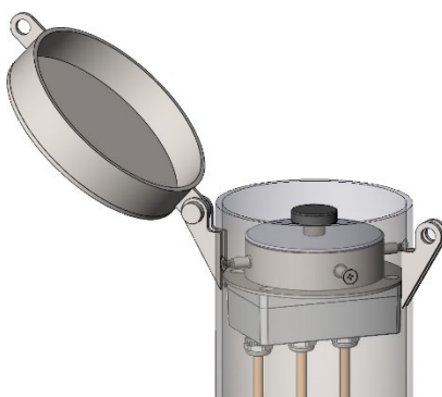
Рисунок 8 – Трехпозиционный переключатель в надземной части головного модуля
