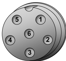
Рисунок 4 – Положение контактов разъема PY07-6
