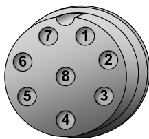
Рисунок 3 – Положение контактов разъема PY07-8
