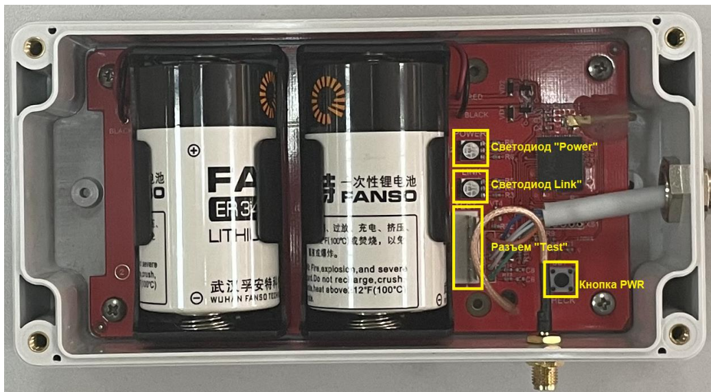
Рисунок 2. – Внешний вид платы электронного блока контроллера термокосы ThLG-D22-EXi
