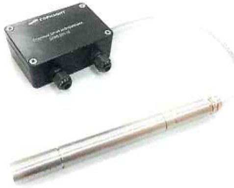
Рисунок 3 – Общий вид датчиков деформации струнных SVWG-D01
