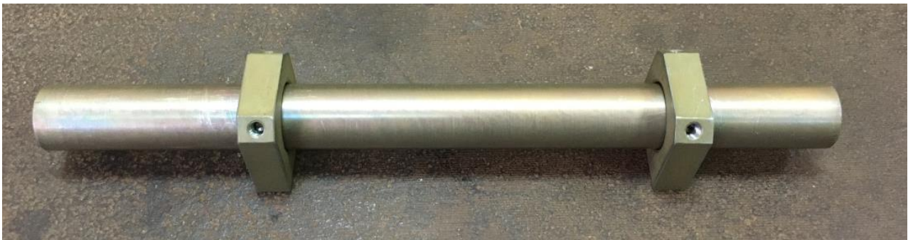
Рис.2 – Крепления анкеров на установочный шаблон.
